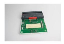
La plaque d'essai II ou carte de prototypage (protoboard) fait de l'unité centrale COM4LAB un environnement de développement pour les circuits électroniques.
