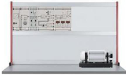
Les expériences sont mises en place avec des plaques expérimentales dans un cadre profilé. Le Profi-CASSY est utilisé pour contrôler ce système technique ainsi que pour enregistrer et évaluer les valeurs mesurées.
