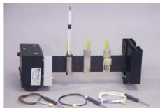
Le kit d'échangeur de chaleur TK2941H comprend une barre chauffante, trois transducteurs de chaleur et un interrupteur bimétallique ainsi que des accessoires de détection de température.
