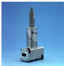
L'ondemètre est constitué par une cavité résonante cylindrique.
