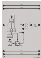
pour la démodulation de modulations delta linéaires et adaptables. Le démodulateur delta comprend: récupération de l'horloge, registre à décalage, expandeur, intégrateurs, modulateur PAM et passe-bas de sortie.
