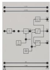
A partir du signal modulant, il est généré une modulation d'impulsions en durée PDM par le pas intermédiaire de l'échantillonnage (établissement d'une PAM(MIA)) selon le procédé des impulsions en dents de scie.
