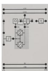
Le démodulateur PTM (MIT) reconvertit les modulations d'impulsions dans le temps PPM (MIP) et PDM (MID) en PAM (MIA).
