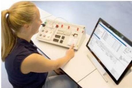
**Système d'entraînement pour le bus d'installation européen - le système de base EIB/KNX**
