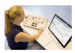
Système d'entraînement pour le bus d'installation européen - le système de base EIB/KNX
