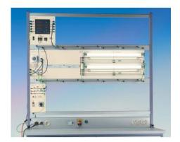
E4.1.1.6 Installation avec des lampes fluorescentes (système de plaques)
