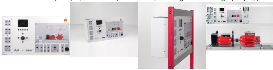
Module de commande CASSY pour l'analyse des machines électriques et à la simulation des charges.
