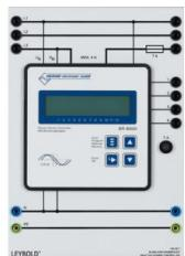
Régulateur électronique de puissance réactive avec affichage du cos f.
