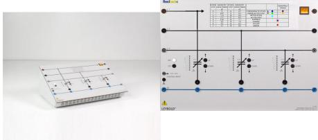
Charge capacitive triphasée, robuste et à usage universel, avec une puissance absorbée réglable jusqu'à 1 kvar. La capacité de chaque phase peut être modifiée individuellement en 15 pas, de 1,7 µF à 26,3 µF.
