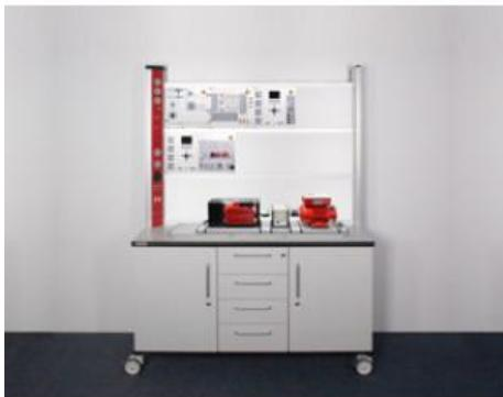
L'équipement permet l'analyse de la machine synchrone à excitation permanente à commutation sinusoïdale (PMSM) avec des aimants de surface.
