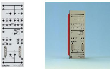
Cette plaque permet: la réalisation d'expériences de base avec le redresseur-commutateur de tension universel, la commande manuelle des transistors de puissance et/ou la sortie de tous les signaux d'état, des signaux de commande ainsi que des signaux de valeur réelle du courant avec isolement galvanique. Entrées/Sorties (niveau TTL):
