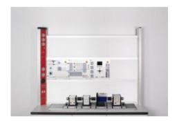
E2.6.1.1 Bases de la commande du moteur synchrone autopiloté, ou servo moteur CA
