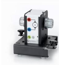
Sert à mesurer la vitesse de rotation des machines électriques des gammes 0,1 et 0,3 kW.
