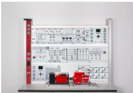
La partie électronique de puissance de ce stage de laboratoire travaille avec des plaques expérimentales. La machine électrique utilisée est une machine industrielle dont les caractéristiques sont évaluées à l'aide du système de test de machines 0,3.
