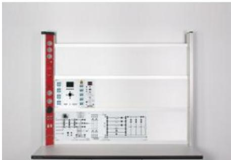
Les expériences sont réalisées avec des plaques d'expérimentation dans le cadre d'expérimentation. Les redresseurs non commandés/commandés avec support de masque représentent le schéma fonctionnel et le schéma de flux de signaux et permettent un montage clair des circuits expérimentaux. Le raccordement central des câbles d'allumage, surveillé par un µ-processeur, permet un changement rapide du circuit du convertisseur.
