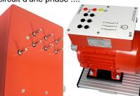
Le simulateur de défauts permet, en combinaison avec les moteurs asynchrones triphasés à cage d'écureuil, de simuler des défauts typiques tels que le défaut à la terre, l'interruption de l'enroulement, le défaut de spire, le défaut d'enroulement et la réponse du thermocontact.
