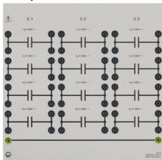
Trois batteries de condensateurs à papier métallisé comprenant chacune 4 condensateurs.
