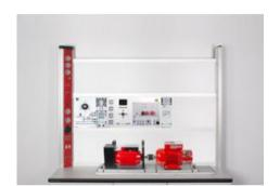
E2.3.3.1 Banc d'essais de moteur universel CA 1.0 kW avec charge active 4 Q, interface PC USB, mesure U I, n, T
