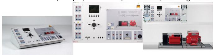
Le test de machines CASSY fait partie du système de test de machines destiné à l'analyse des entraînements électriques et à la simulation des charges des machines. De forme compacte, cet appareil peut être utilisé dans le cadre d'expérimentations ou comme appareil de table.
