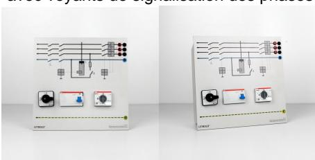
Pour connecter l'alimentation triphasée pendant des expériences avec des charges électriques alimentées par des tensions de ligne de 400 V.
