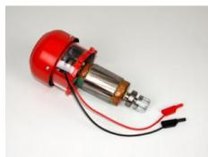
Le rotor est préparé à l'engagement dans le stator de modèle d'appareil 7747720.
