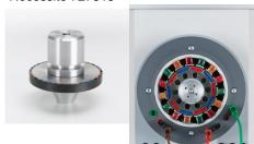
Roue polaire avec 20 aimarus encastrés, à utiliser dans le stator 727 815. Deux aimants sont respectivement réunis pour ainsi former un pôle. Les pôles nord et sud sont marqués en couleur.
