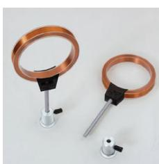
Pour la génération d'un champ magnétique homogène, par ex. pour des expériences avec les tubes de démonstration LD.
