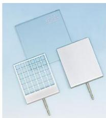
Pour l'étude de l'effet photoélectrique et de la conductivité de l'air par ionisation. Électrodes avec fiche de 4mm pour le montage et la connexion électrique. Avec plaque en verre.
