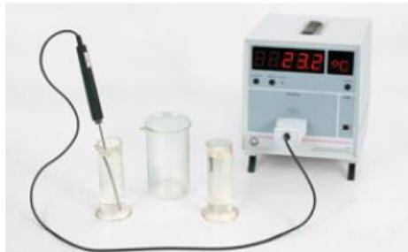
Mesure de la température de mélange de l'eau chaude et de l'eau froide.
