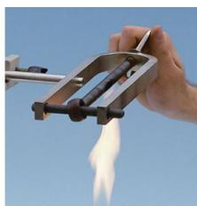
Pour démontrer les forces mises en jeu dans des solides en cas de variation de la température. Comprend un étau en U, une tige de serrage avec vis à oreilles et une tige de fixation pour l'étau. Livré avec 10 boulons ( 38117 ).
