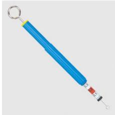
Avec curseur de réglage du zéro pour l'ajustement de la tare variable en fonction de l'expérience réalisée (plateau de balance, poulie).
