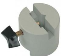
Pied cylindrique avec vis de fixation pour le serrage de plaques ou de tiges ; le dessous comporte une rainure rectangulaire qui lui permet de coulisser sur une règle graduée (par ex. 31102). La rainure médiane du dessus permet de fixer une règle graduée.
