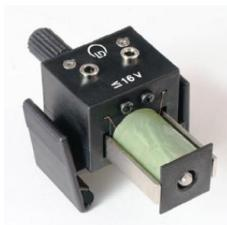
Électro-aimant permettant de déclencher un déplacement à un moment précis, par ex. à l'aide de l'adaptateur pour aimant de maintien avec déclencheur ( 336 25 ) ; avec noyau de fer à réglage axial pour la réduction des retards à l'aimantation.
