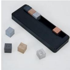
Pour déterminer directement, par pesage, la masse volumique de différents matériaux ; dans bloc de rangement.
