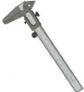
Permet d'effectuer des mesures d'intérieur (alésage), d'extérieur (diamètre) ou de profondeur.
