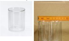
Calorimètre de démonstration pour la détermination des enthalpies de dissolution et de neutralisation.
