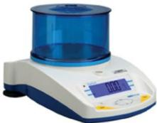
Balance de précision portable à plateau rond, avec plusieurs unités de pesage et interfaces RS-232 et USB, avec batterie rechargeable (adaptateur/chargeur inclus), crochet de pesée pour les mesures de densité et de poids spécifique et bouclier anti-dérapant amovible. Empilable.
