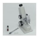
Permet la mesure des indices de réfraction d'échantillons liquides et solides pour une lumière de longueur d'onde ?= 589,3 nm ainsi que la détermination de la dispersion moyenne, avec échelle de la teneur en sucre, dispositif d'éclairage, étalon avec indice de réfraction, flacon avec liquide de contact, thermomètre et clé d'ajustage.
