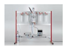
Dans l'expérience C2.3.1.3., on détermine le pouvoir calorifique supérieur du fuel à l'aide d'un calorimètre de démonstration.
