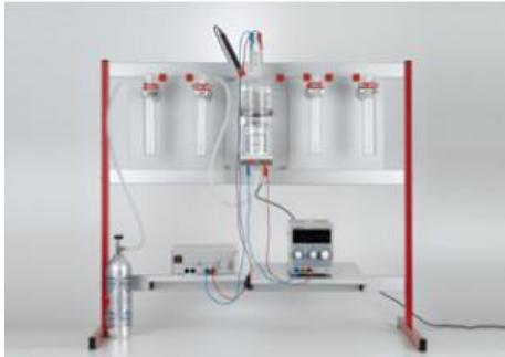
Dans l'expérience C2.3.1.3., on détermine le pouvoir calorifique supérieur du fuel à l'aide d'un calorimètre de démonstration.
