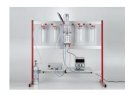
Dans l'expérience C2.3.1.1, on brûle du charbon et on détermine le pouvoir calorifique supérieur à l'aide d'un calorimètre.
