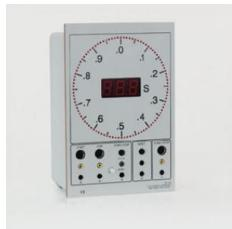
Compteur de temps brefs avec affichage quasi-analogique en 0,01 s par 100 diodes luminescentes disposées en cercle.
