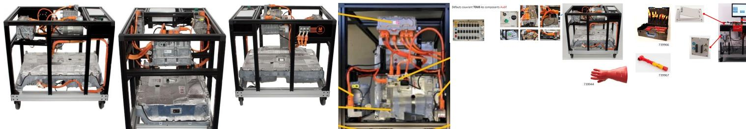
Le système offre un aperçu de tous les composants HV facilement accessibles, provenant d'un véhicule : batterie, câbles, chauffage, climatisation, l'électronique de puissance. Les travaux nécessaires à la consignation peuvent être effectués à l'identique du véhicule dans des conditions plus simples.
