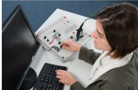
Il est désormais possible de créer des dysfonctionnements reproductibles rencontrés dans un véhicule en vue d'en analyser l'incidence sur les émissions à laide du système OBD2/EOBD.
