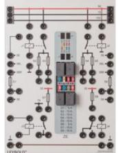
La Centrale électrique (ZE) est un module électrique centralisé dans lequel des parties du câblage d'automobile sont réunies pour fusionner des composants (bloc de fusibles) ou des relais de commutation. Il est utilisé pour la distribution centrale de la tension de batterie borne 30 et la tension connectée à la borne d'allumage borne 15 avec le contrôle d'éclairage conventionnel.
