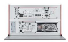
Le législateur exige une correction automatique de la portée déclairage pour les phares au xénon. Ce système dapprentissage avec simulation intégrée de laccélération et du freinage (commutable) comprend une correction automatique et dynamique de la portée déclairage en vue de compenser les variations de la hauteur de caisse et donc de linclinaison de laxe du faisceau lumineux produit par les phares dun véhicule.
