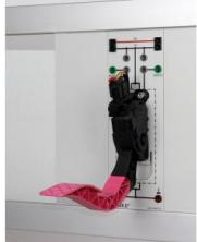
Capteur de pédale d'accélérateur d'origine moderne avec interface SENT (Single Edgeibble Transmission) selon SAE J2716 TM et résistance de rappel intégrée pour une expérimentation facile. L'interface SENT du capteur de pédale d'accélérateur prend en charge le mode de canal rapide pour la sortie des positions au format sécurisé 12 bits et le canal lent pour la sortie de données supplémentaires.
