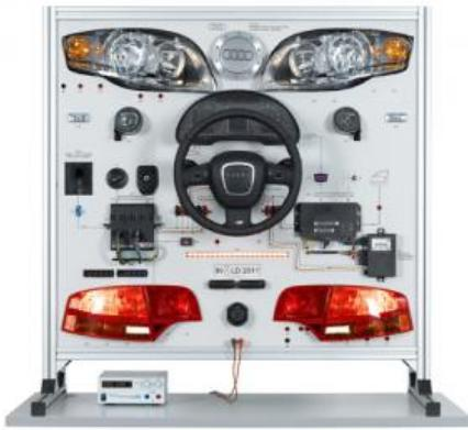
Le panneau didactique Éclairage se compose d'un porte-instruments moderne avec dispositif antidémarrage électronique, toute l'électronique du volant, le module central du système de confort et l'unité électrique centrale à gestion électronique.
