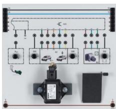
Capteurs à brancher au calculateur ABS/ESP constitués d'une simulation de la pédale d'accélérateur pour la spécification du couple moteur, d'un capteur d'angle de rotation et d'accélération transversale ainsi que d'une pédale de frein.
