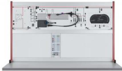
Détection des angles morts : 2 transducteurs à ultrasons détectent si un autre véhicule se trouve dans la zone latérale du véhicule et le signalent par un avertissement optique.
