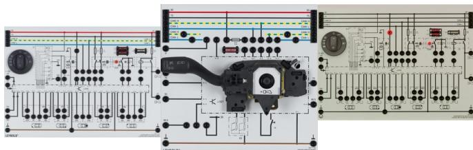
Comprend une unité de contrôle du réseau de bord et le système électronique de colonne de direction.
