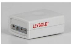
Permet de raccorder deux thermocouples NiCr-Ni (type K) pour la mesure de la température et de la température différentielle avec CASSY ( 524013 , 524006 , 524005W , 524018 ) ou les instruments de mesure universels ( 531835 , 531836 , 531837 ).
