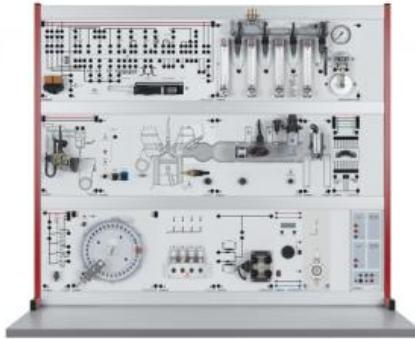
Le système LH-Motronic est réalisé à partir de plaques d'expérimentation classiques avec au dos, le câblage pour le transfert des signaux. Ce montage permet ainsi d'étudier tous les composants d'un système de gestion moderne de l'allumage et de l'injection à distribution statique ainsi que de l'injection multipoints.
