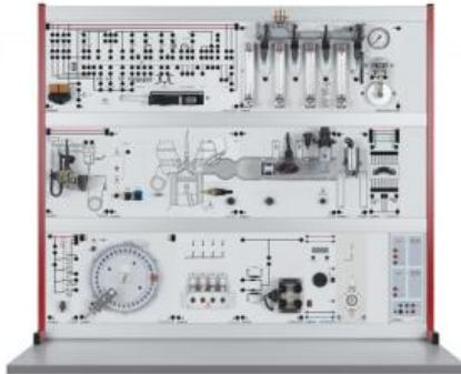
Le système LH-Motronic est réalisé à partir de plaques d'expérimentation classiques avec au dos, le câblage pour le transfert des signaux.
