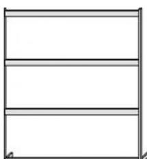
Cadre à trois étages pour plaques d'expérimentation, hauteur A4 ; version autonome.
