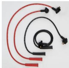
4 câbles d'allumage spéciaux avec connecteur intégré verrouillable pour raccordement à la bobine d'allumage DIS 738517 .
