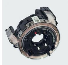
Capteur photoélectrique de l'angle de braquage seulement en complément du module colonne de direction 738 111-02 associé au combiné d'instruments 739 6021 pour l'acquisition de l'angle de braquage via le bus CAN propulsion (highspeed).
