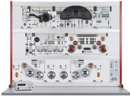
Le dispositif déclairage conventionnel dun véhicule est construit pour la circulation sur route droite. À l'amorce dun virage et aux intersections, la portion de route située juste devant le véhicule est par conséquent éclairée de manière insuffisante.
