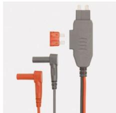
Adaptateur de contrôle bipolaire avec douilles de 4 mm et câbles de mesure à utiliser dans un porte-fusibles automobile. Se branche à un multimètre afin de pouvoir alimenter une tension ou encore de mesurer le courant absorbé par des consommateurs ou des courants de fuite sans avoir à débrancher de câble.
