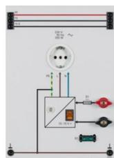
Onduleur automobile qui génère une tension alternative de 230 V à partir de 10 - 15 V CC du tableau de bord pour ainsi faire fonctionner dans la voiture tout appareil électrique habituellement alimenté sur secteur. Avec protection surtension/sous-tension et protection contre la surchauffe ainsi que des voyants LED indicateurs de l'état.
