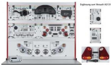
Dans le cas d'installations d'éclairage avec calculateur du circuit de bord commandées avec le bus CAN, la prise remorque ne doit pas être raccordée en parallèle aux feux arrière existants.
