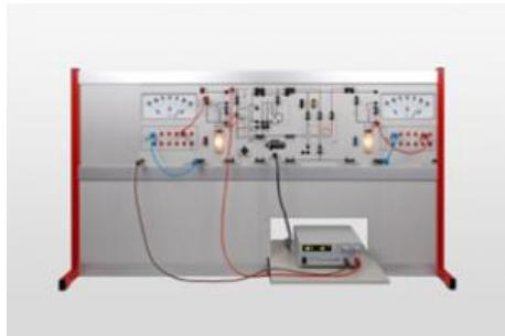
Dans cette série d'expériences, la fonction du stabilisateur de tension est étudiée dans les véhicules équipés d'un système de démarrage/arrêt.
