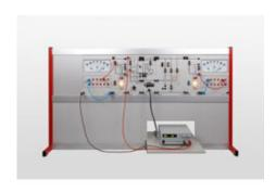
Dans cette série d'expériences, la fonction du stabilisateur de tension est étudiée dans les véhicules équipés d'un système de démarrage/arrêt.
